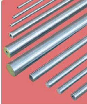
Barre in acciaio al carbonio cromate tipo "LUS" toll. f7 EN 10083/1:2 C45
